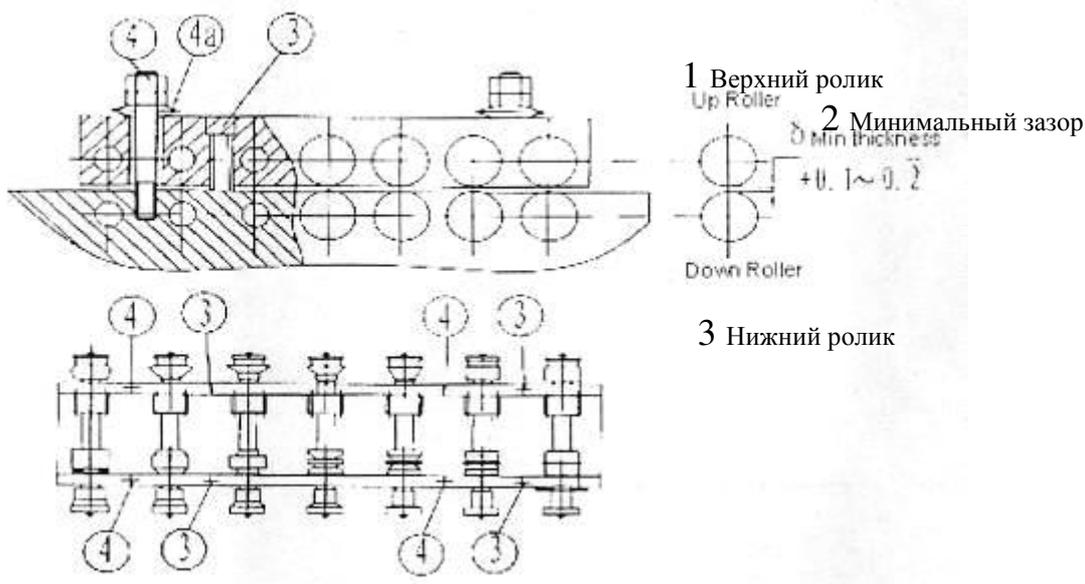
1 – верхний ролик; 2 – минимальная толщина; 3 – нижний ролик.
